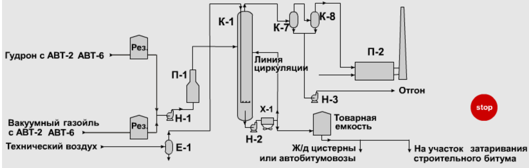
Принципиальная схема производства нефтяных битумов
