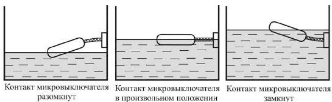
Рис.22 Принцип действия поплавкового сигнализатора
